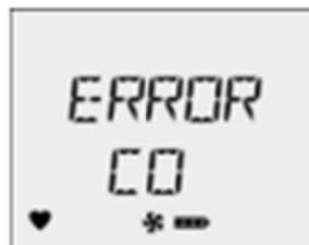
Các cảm biến bị lỗi khi Span ( kiểm tra khí áp dụng) , giữ lại giá trị Span trước và không tiếp tục quá trình hiệu chuẩn
