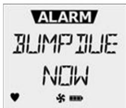
Cấp khí trong khi BUMP DUE NOW hiển thị. Xác nhận báo động hình ảnh, âm thanh, và rung kích hoạt. Máy dò phải nhập báo động để vượt qua Bump Test . Để thực hiện quy trình, tham khảo Bump Test.
