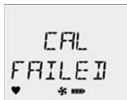
Note : Nếu hiệu chuẩn không thành công đối với (các) cảm biến, ngày hết hạn hiệu chuẩn không thể được đặt cho (các) cảm biến bị lỗi
