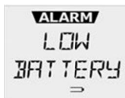
Báo động pin yếu tiếp tục 10 phút. Nếu điện áp pin giảm quá thấp, máy sẽ kích hoạt báo động tắt tự động.
