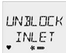
Note : Nếu ống không được chặn và mở ra sau 2,5 phút thì máy sẽ cho rằng ( xác nhận) bơm bị lỗi và bị vô hiệu hóa
