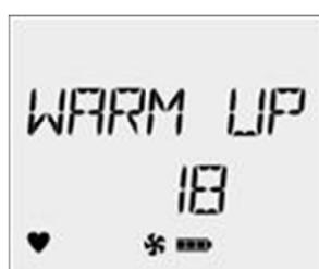
Màn hình LCD đếm ngược thời gian còn lại (tính bằng s) để bơm nóng lên
