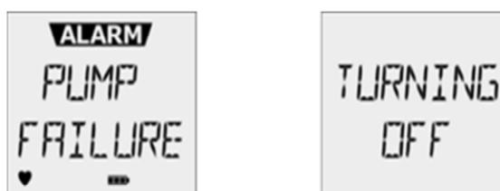
Kích hoạt lại máy, nếu bơm tiếp tục bị lỗi lần nữa tham khảo mục [Xử lý sự cố](#)
