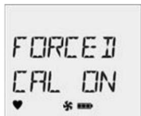
Các cảm biến phải được hiệu chỉnh để tiếp tục và đi vào hoạt động bình thường . Để được hướng dẫn đầy đủ, hãy tham khảo **Hiệu chuẩn**
